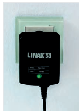
Elektronisches Schaltnetzteil (Switch Mode), direkt hinter Netzstecker integriert (24 Volt-Antriebssystem serienmäßig)
